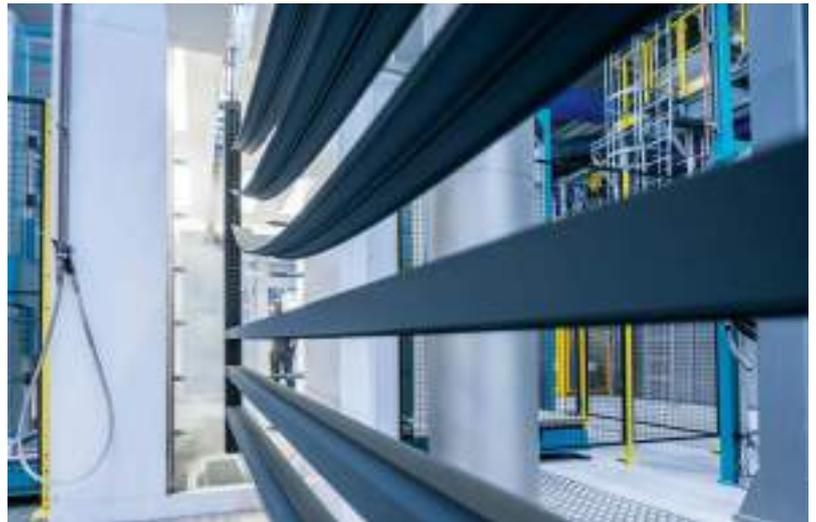
Die Anlage ist für Aluminiumprofile bis sieben Meter Länge konzipiert, der jährliche Durchsatz liegt bei etwa 540.000 Quadratmetern.
