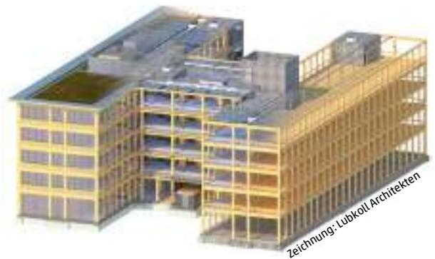
3D-CAD-Modell des H-förmigen Holzskelettbauwerks. Die Größe der Büroräume orientiert sich am Achsraster von 2,70 m in Querrichtung.
