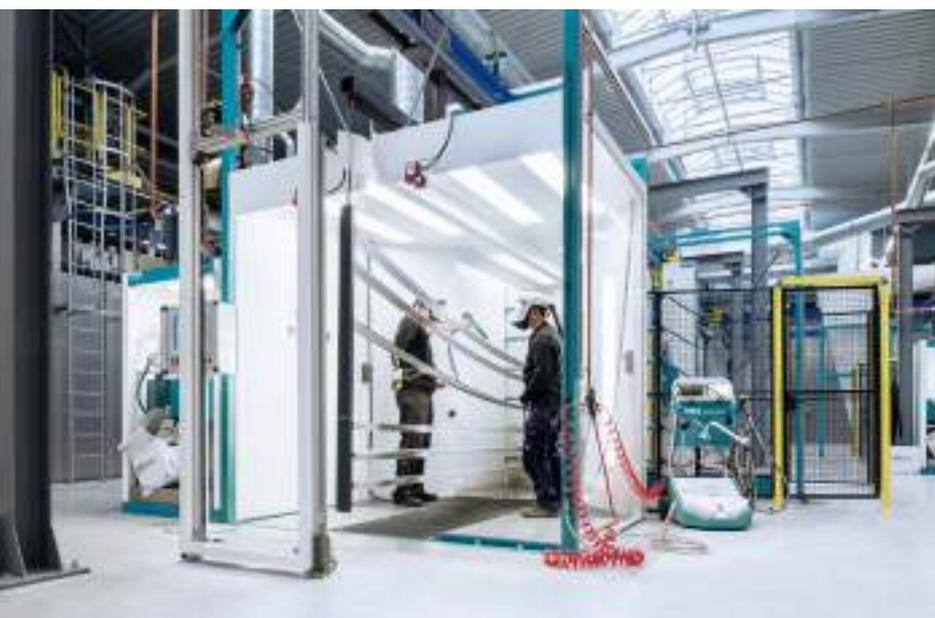
Die Pulverbeschichtungsanlage von TS-Aluminium hat eine Gesamtfläche von rund 2.000 Quadratmetern. Zwei Pulverkabinen lassen sich unabhängig voneinander nutzen.
