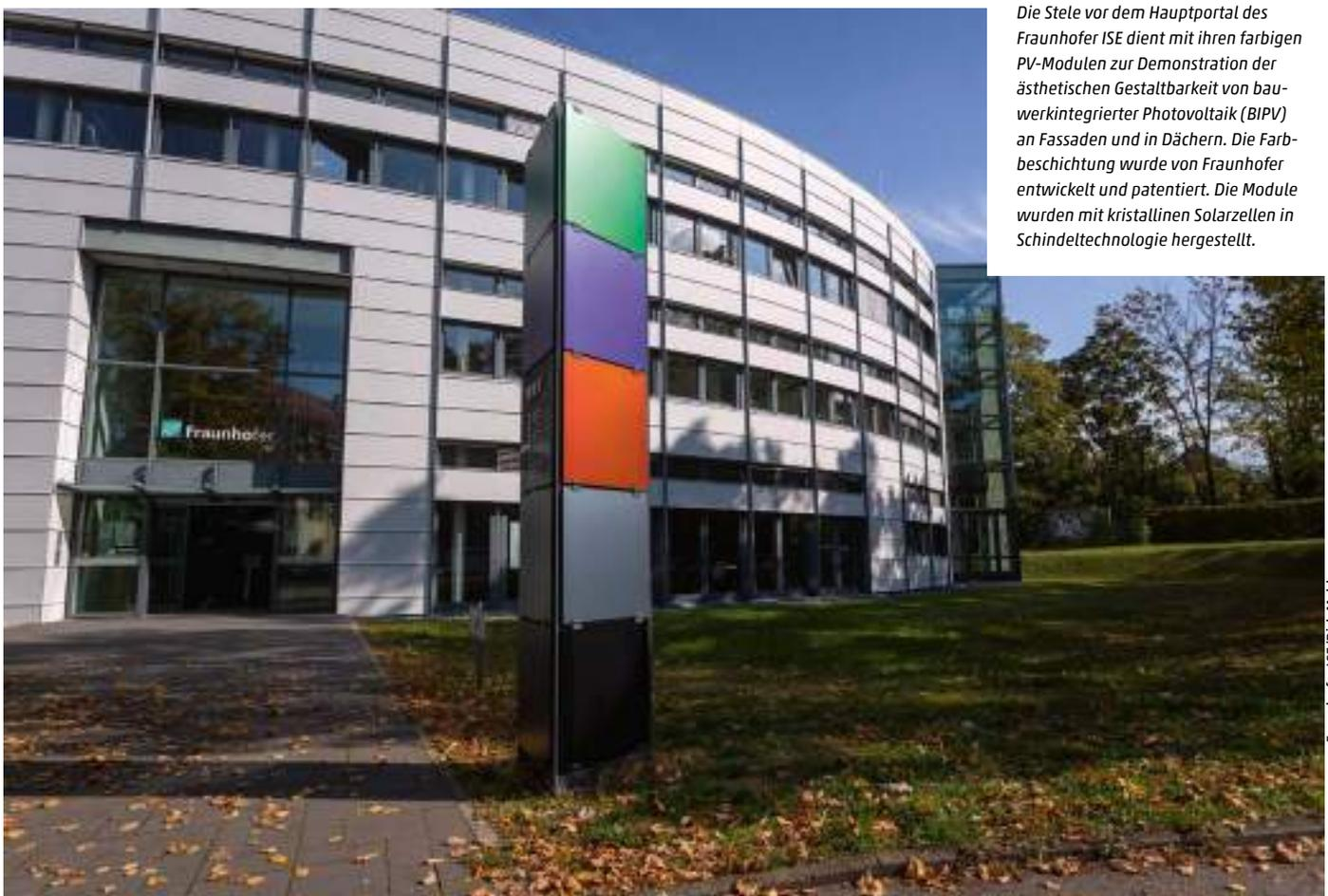
Die Stele vor dem Hauptportal des Fraunhofer ISE dient mit ihren farbigen PV-Modulen zur Demonstration der ästhetischen Gestaltbarkeit von bauwerkintegrierter Photovoltaik (BIPV) an Fassaden und in Dächern. Die Farbbeschichtung wurde von Fraunhofer entwickelt und patentiert. Die Module wurden mit kristallinen Solarzellen in Schindeltechnologie hergestellt.
