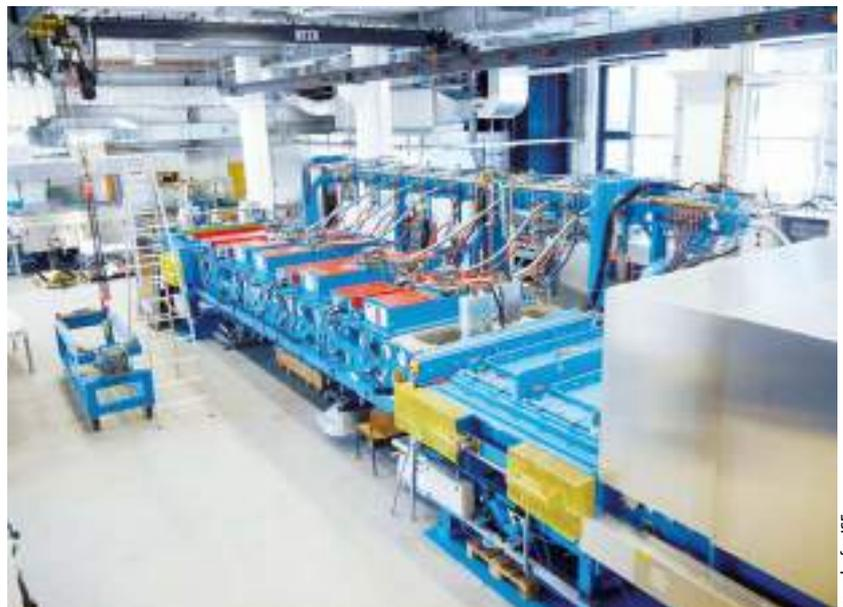
Horizontale Sputteranlage mit einer Beschichtungsfläche von 1,5 x 4 Meter.
